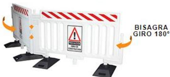
**DESCRIPCIÓN:** Valla plástica para seguridad vial. Construida en material de polietileno de media densidad (PEMD). Sistema de encastre por bisagra que permite un giro de 180°. 2 bases de contrapeso de 6 k cada una. Apta para ser montada en canalizador vial Conoflex modelo Yersey.
