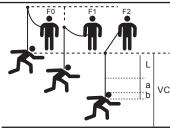
L= longitud del amarre a= despliegue de amortiguador
