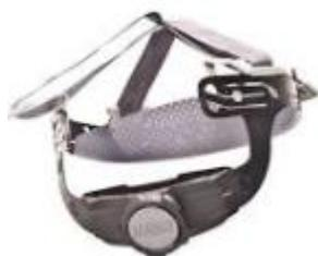
A Suspensão Fas-Trac III (tipo catraca) é composta por cinta/fita dupla em poliamida, carneira em PEAD de alta densidade e testeira absorvedora de suor produzida em laminado de PVC atóxico revestida com espuma multiperfurada de poliuretano que garante proteção e conforto ao usuário. Por não configurar um EPI de forma isolada (somente a suspensão), todas as suspensões MSA são testadas e aprovadas para uso e compõem os CAs dos Capacetes de segurança industrial Classe A e Classe B da MSA.
